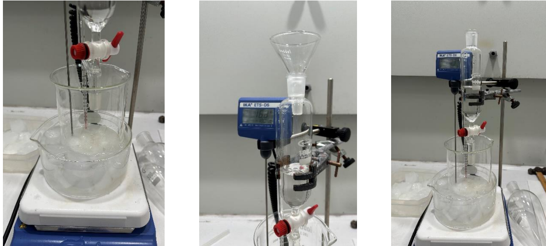
Figura 22: Disposición de la disolución de celulosa triturada en vaso de precipitado sobre baño de hielo (izquierda), ácido sulfúrico en un embudo de decantación sujeto por un soporte con pinza (centro), y configuración final sobre agitador magnético y placa calefactora (derecha). Fuente: Elaboración propia.
