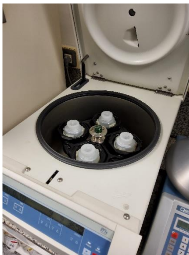
Figura 24: Configuración de la primera centrifugación una vez colocados los 4 botes con la misma cantidad de disolución. Fuente: Elaboración propia.
