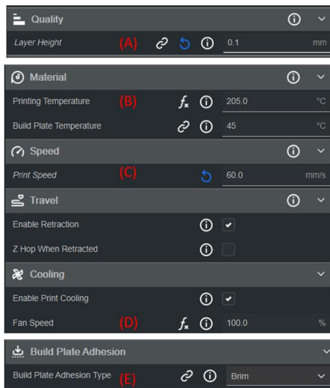
Figura 21: Parámetros configurados en BCN3D Stratos para un scaffold AAC de fracción en volumen de 28. (A) altura de capa de 0.1mm, (B) temperatura de impresión de 205 °C , (C) velocidad de impresión de 60 mm/s,(D) relleno al 100 %, (E) adhesión al plato tipo Brim.
