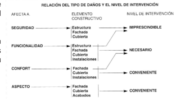
Imagen 153: Relación Tipo de Daño y Nivel de Actuación Fuente : Tratado de Rehabilitación Tomo II
