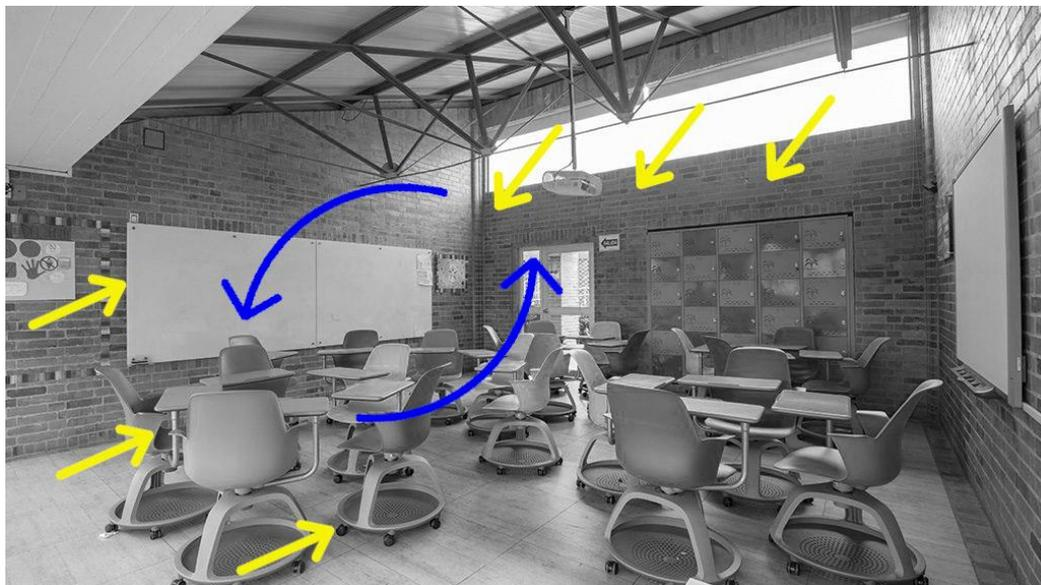
**Figura 1.29.** Fotografía del proyecto El Gimnasio La Fontana, se resalta el sistema de iluminación y ventilación cruzada. Salmona, Rogelio (1992-2005). Bogotá, Colombia.
