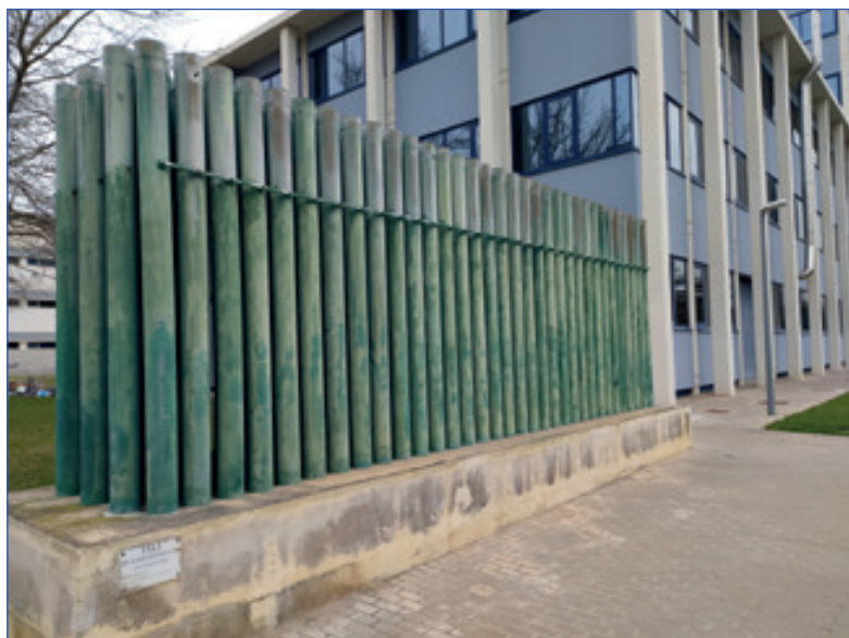
Foto 1. Primer prototipo de pantalla acústica basada en CS, situada en el campus de Vera de la Universitat Politècnica de València.
