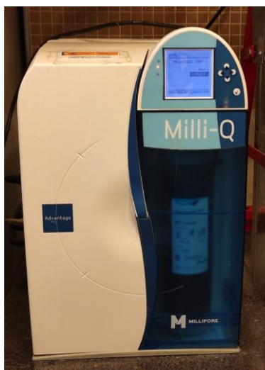
Figura 9. Equipo de ultra-purificación de agua
