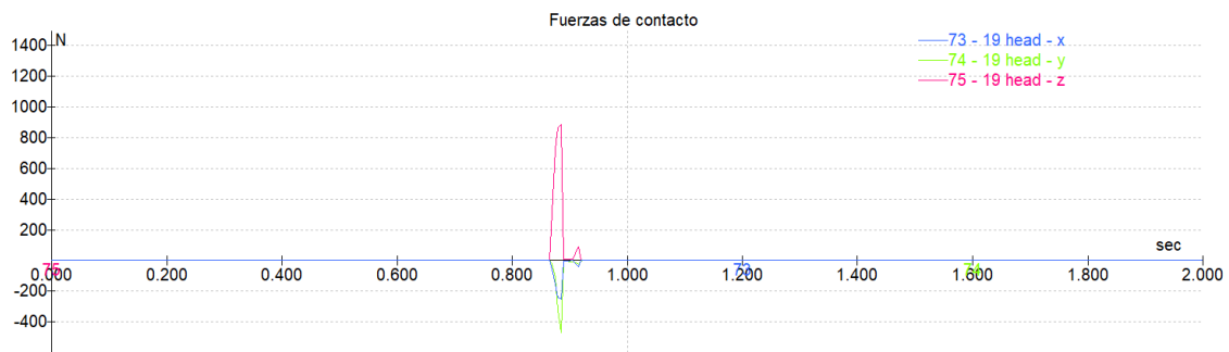
Figura 155. Evolución de la fuerza de contacto en la cabeza a lo largo de la caída (10°/5 km/h)
