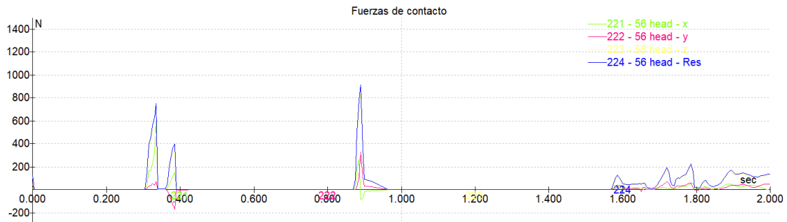
Figura 97. Evolución de la fuerza de contacto en la cabeza a lo largo de la caída (10° / 10 km/h)
