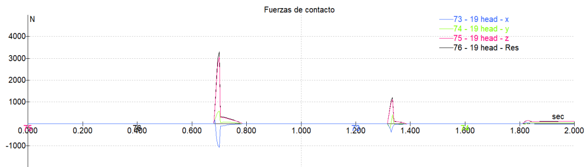
Figura 66. Evolución de la fuerza de contacto en la cabeza a lo largo de la caída (10° /10 km/h)
