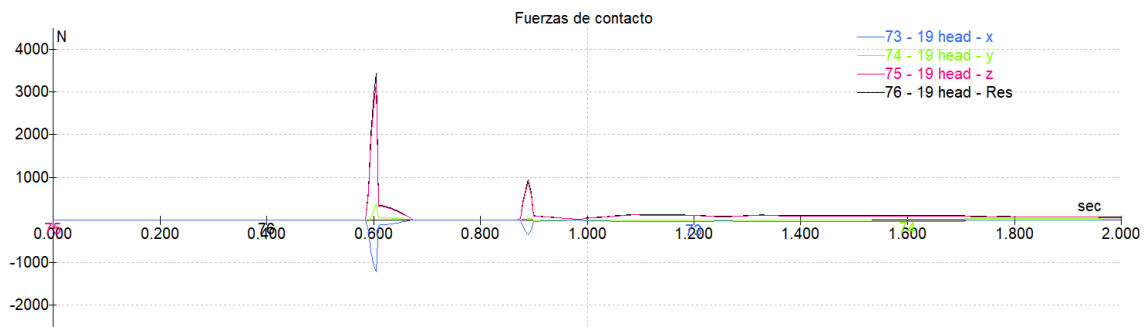
Figura 44. Evolución de la fuerza de contacto en la cabeza a lo largo de la caída ( 10^\circ / 25 km/h)
