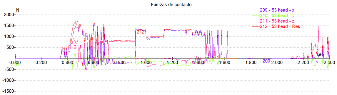
Figura 248. Evolución de la fuerza de contacto en la cabeza a lo largo de la caída (10°/5 km/h)
