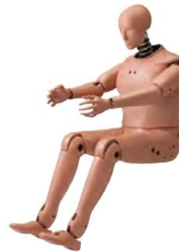
Figura 25. Modelo Hybrid III 95 th Percentile Large Fuente: (Jasti Co., LTD., s. f.)
