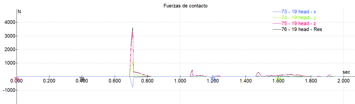
Figura 47. Evolución de la fuerza de contacto en la cabeza a lo largo de la caída (40° /5 km/h)
