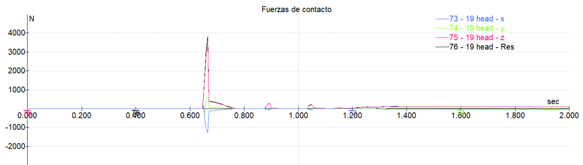
Figura 35. Evolución de la fuerza de contacto en la cabeza a lo largo de la caída (10° / 10 km/h)
