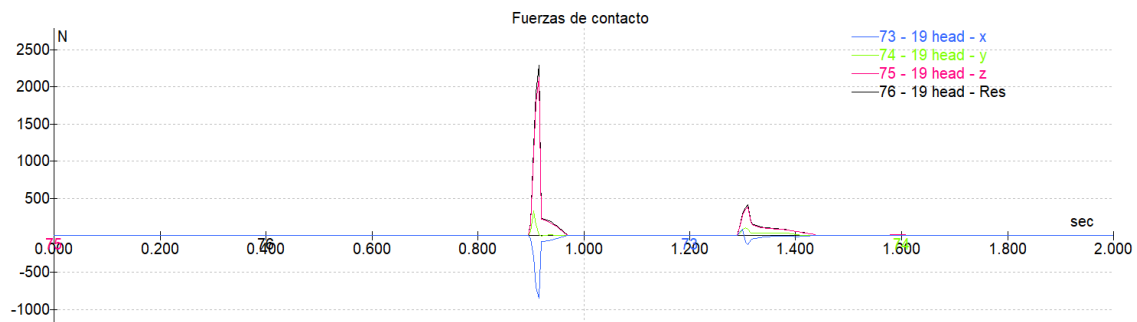
Figura 189. Evolución de la fuerza de contacto en la cabeza a lo largo de la caída (10° / 10 km/h)
