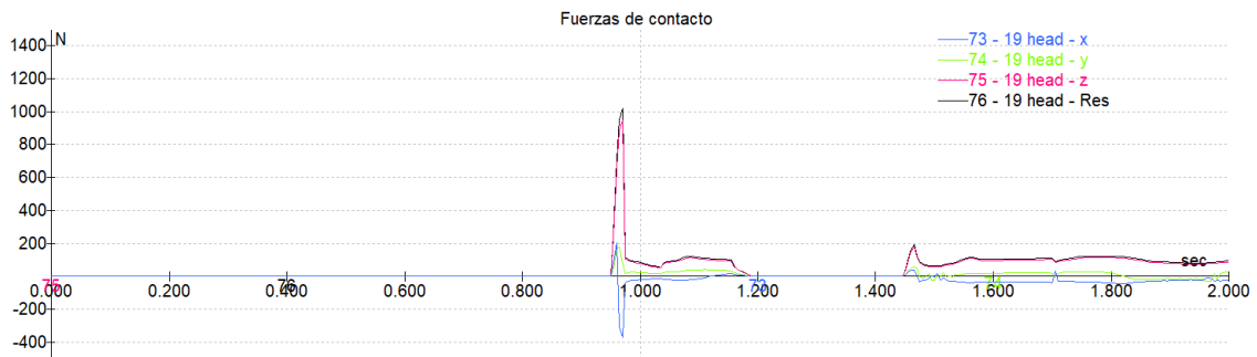
Figura 201. Evolución de la fuerza de contacto en la cabeza a lo largo de la caída (0° /5 km/h)
