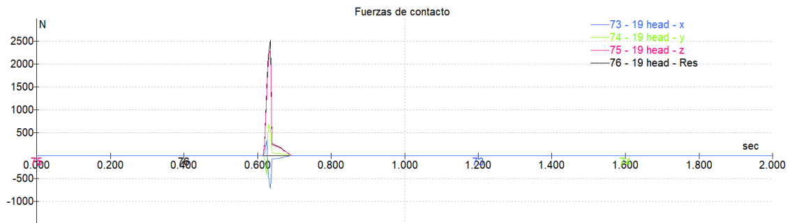
Figura 53. Evolución de la fuerza de contacto en la cabeza a lo largo de la caída (40° / 15 km/h)
