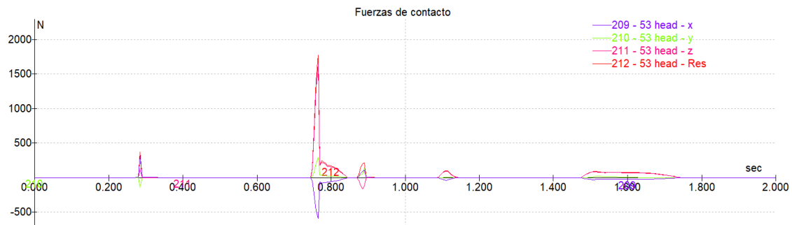
Figura 275. Evolución de la fuerza de contacto en la cabeza a lo largo de la caída (0° /25 km/h)
