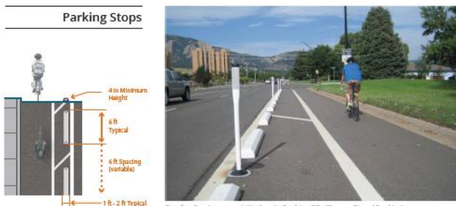
Figura 13. Barreras lineales bajas (barreras usadas en aparcamientos)
