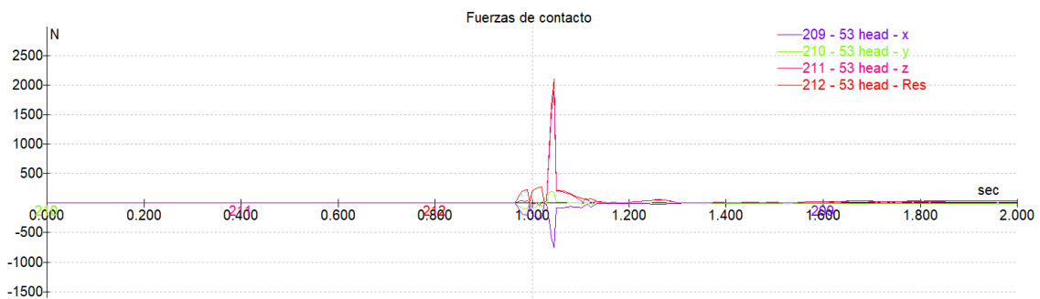
Figura 241. Evolución de la fuerza de contacto en la cabeza a lo largo de la caída (0° /20 km/h)
