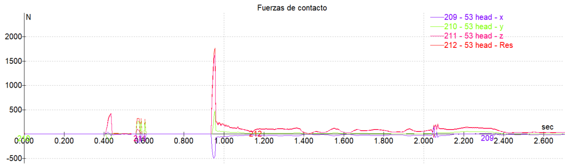
Figura 136. Evolución de la fuerza de contacto en la cabeza a lo largo de la caída (10° /25 km/h)
