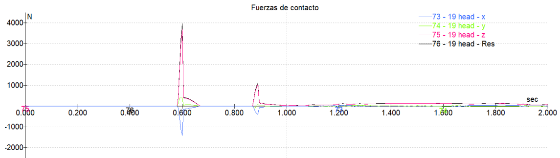
Figura 176. Evolución de la fuerza de contacto en la cabeza a lo largo de la caída (0° / 15 km/h)
