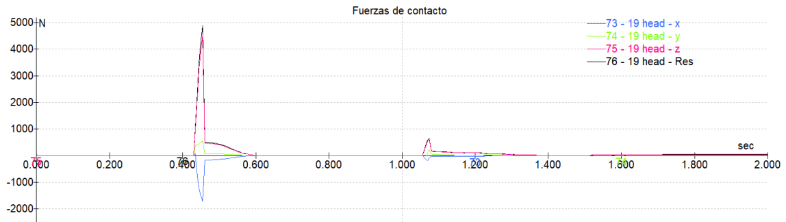
Figura 213. Evolución de la fuerza de contacto en la cabeza a lo largo de la caída (0° /25 km/h)
