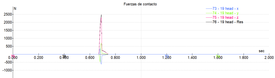
Figura 50. Evolución de la fuerza de contacto en la cabeza a lo largo de la caída (40° /10 km/h)
