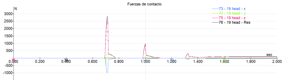
Figura 164. Evolución de la fuerza de contacto en la cabeza a lo largo de la caída (10° /20 km/h)
