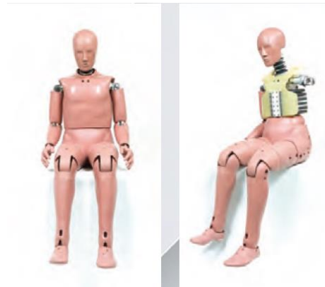
Figura 24. Modelo Hybrid III 50 th Percentile Male Fuente: (Jasti Co., LTD., s. f.)
