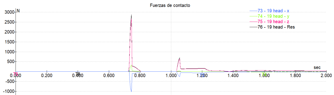
Figura 195. Evolución de la fuerza de contacto en la cabeza a lo largo de la caída (10° / 20 km/h)
