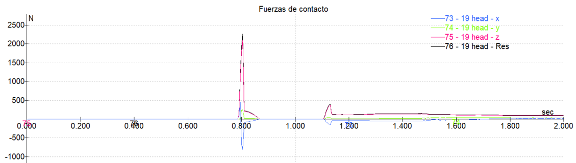
Figura 192. Evolución de la fuerza de contacto en la cabeza a lo largo de la caída (10° /15 km/h)
