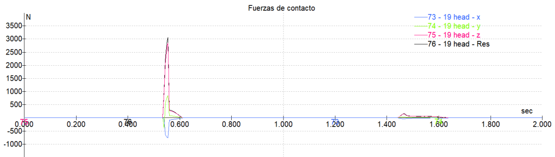
Figura 90. Evolución de la fuerza de contacto en la cabeza a lo largo de la caída (40° /25 km/h)
