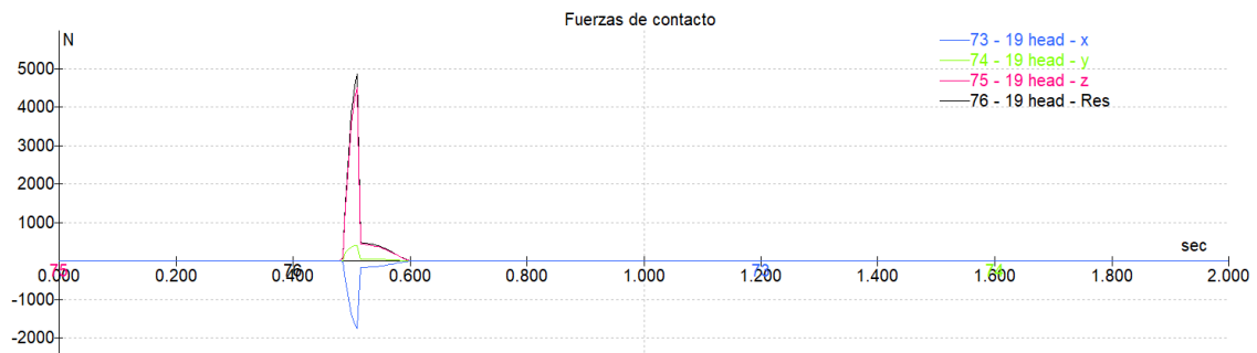
Figura 182. Evolución de la fuerza de contacto en la cabeza a lo largo de la caída (0° / 25 km/h)
