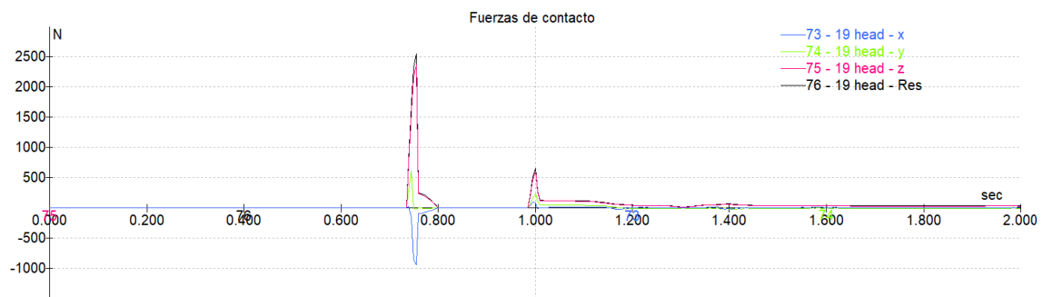
Figura 158. Evolución de la fuerza de contacto en la cabeza a lo largo de la caída (10° /10 km/h)
