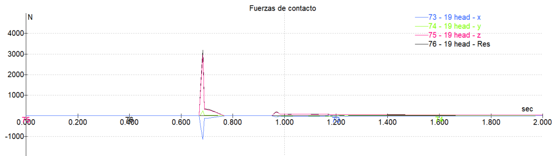
Figura 69. Evolución de la fuerza de contacto en la cabeza a lo largo de la caída (10° /15 km/h)
