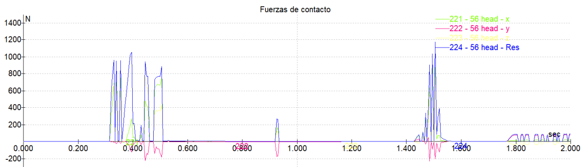
Figura 94. Evolución de la fuerza de contacto en la cabeza a lo largo de la caída (10°/5 km/h)
