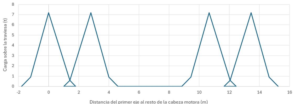
Ilustración 35. Gráfica representativa de la distribución de cargas sobre la traviesa producida por la cabeza motora de la Serie 130. (Elaboración propia)
