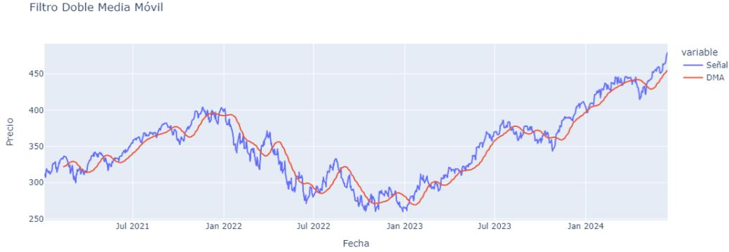
Figura 8: Filtrado con una DMA de periodo 14
