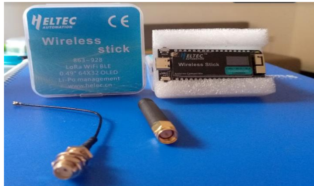
Figura 15 Placa de Desarrollo Wireless stick V3
