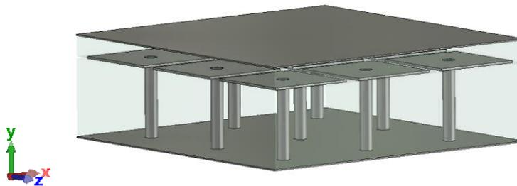
Fig. 8. La cama de "champiñones" metalizados, vista en perspectiva con el dieléctrico transparente. El color gris corresponde al conductor perfecto. Fuente: elaboración propia.
