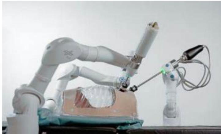
Fig. 1: Operación quirúrgica realizada remotamente mediante brazos robot.
