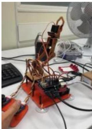
Fig. 9: Control del brazo robótico por control remoto
