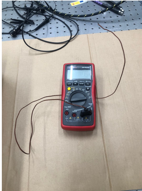
Figura 1.5: Termopar conectado a multímetro. Fuente: propia
