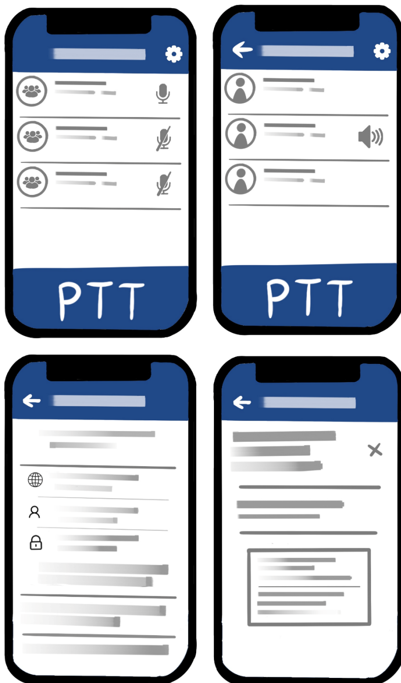
Figura 7. Esquema general de diseño propuesto para las pantallas. De izquierda a derecha y de arriba a abajo: pantalla de grupos, pantalla de participantes de un grupo, pantalla de ajustes y pantalla de conexión con dispositivos Bluetooth Low Energy
