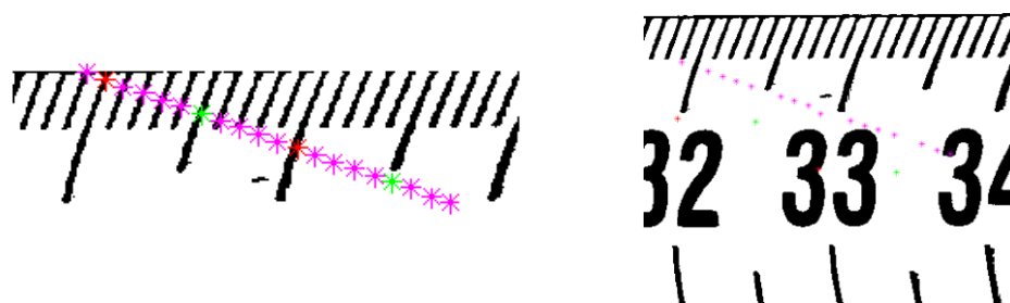
Figura 23. Puntos marcadores de las líneas y sus tipos sobre la imagen original: multiplicados por la componente X (izqda.) y multiplicados por toda la matriz de rotación (dcha.) [Fuente propia]
