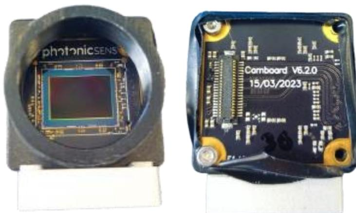
Figura 4.5. Fotografía del PCB Camboard V6.2.0. sin óptica y con mecanizado
