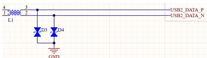
Figura 2.15 Bobina de choque y diodos TVS
