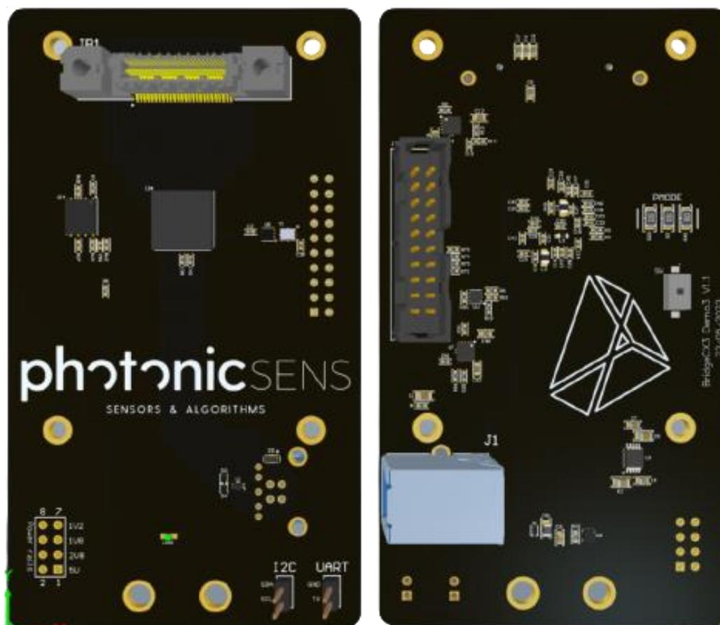
**Figura 2.47.** Visión 3D del TOP y el BOTTOM del producto definitivo V1.1
