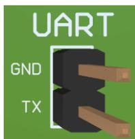
**Figura 2.36.** Captura del 3D del test point de la UART
