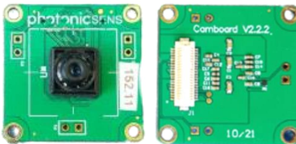
Figura 4.1. Fotografía del PCB Camboard V2.2.2. con óptica
