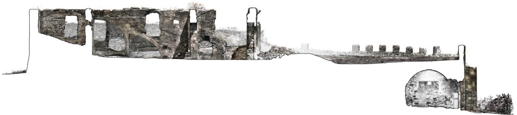
Fig. 5- Castillo de Petrés, Valencia. Sección escáner láser 3D. (Rodríguez-Navarro, Gil-Piqueras)
