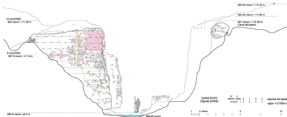
Fig. 6- Sección transversal, aguas arriba, del desfiladero o garganta del Ciervo, representando los restos del estribo izquierdo, la base del derecho y el posible canal aliviadero del embalse. Elaboración propia.
