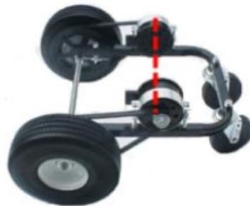
Figura 3: Base diferencial. Fuente: [kadtronix](#)
