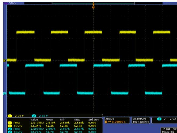
Figura 22: Pulsos del encoder seleccionado. Fuente: [Pololu](#)
