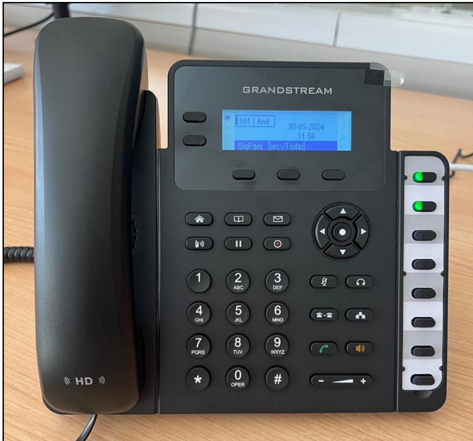
Imagen 72. Teléfono GXP1628 configurado con la extensión 101 de la centralita UCM6302
