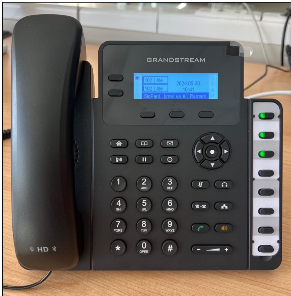
Imagen 78. Teléfono GXP1628 configurado con la extensión 102 de la centralita 3CX
