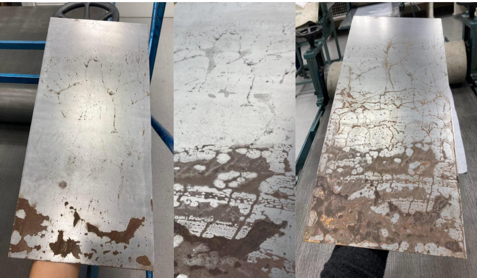
Fig. 72, 73 y 74. Cambios semanales producidos por la oxidación en el taller de grabado. 2024
