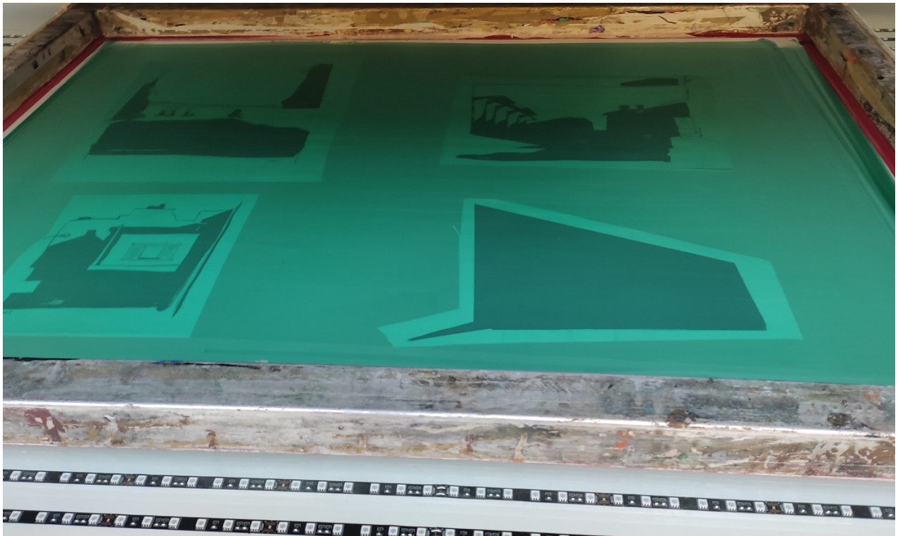
Figura 21, Pantalla serigráfica . Pantalla preparada para realizar la insolación y trasladar los fotolitos a la pantalla, Carla Pérez Fuentes, 2023.
