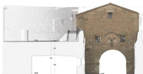
Fig. 3- Alzado y sección del Monumento. Escáner 3D, fotogrametría y dibujo 2D
