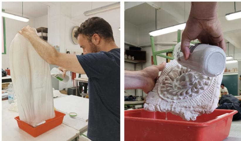
**Fig. 6.** Proceso de esmaltado mediante la técnica del vertido de las piezas I y III.
