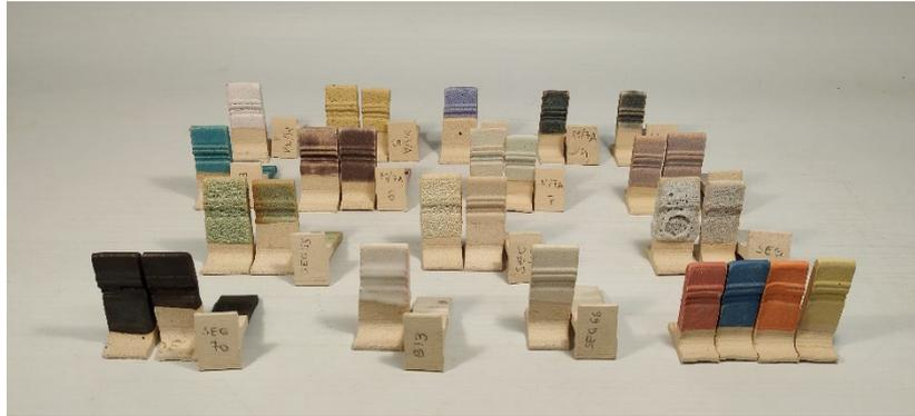
**Fig. 5.** Pruebas de esmaltes de alta temperatura (1250º) en dos tipos de gres.
