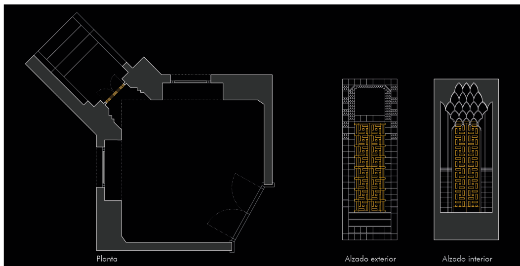
Fig. 11. Planimetría de la esclusa del fumadero de Casa Vicens. Elaboración propia a partir de los archivos originales, 2023.
