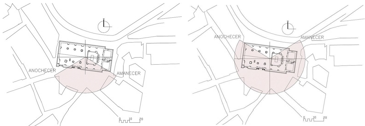
Fig. 2. Alcance de los rayos del Sol en el solsticio de invierno y el solsticio de verano.
