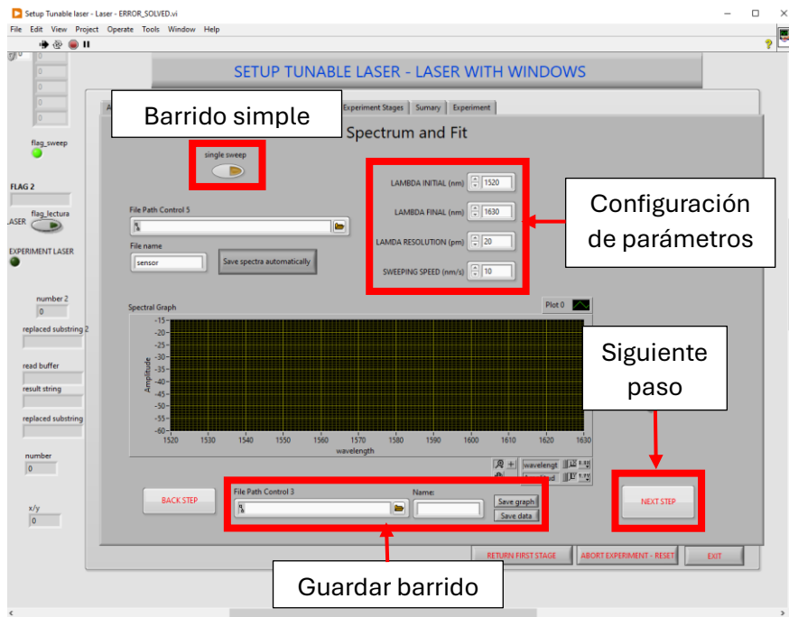
Figura 19. Captura de la ventana “Spectrum and Fit” del programa Setup Tunable Laser
