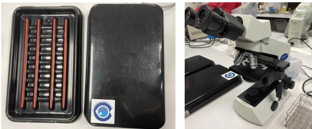
Figura 3.7. Equipos utilizados. Izquierda: cámara de incubación. Derecha: microscopio OLYMPUS
