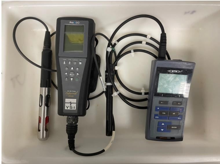
Figura 3.5. Instrumentos de medida usados para evaluar las variables ambientales. A la izquierda, la sonda óptica proODO YSI, a la derecha la sonda WTW 3320
