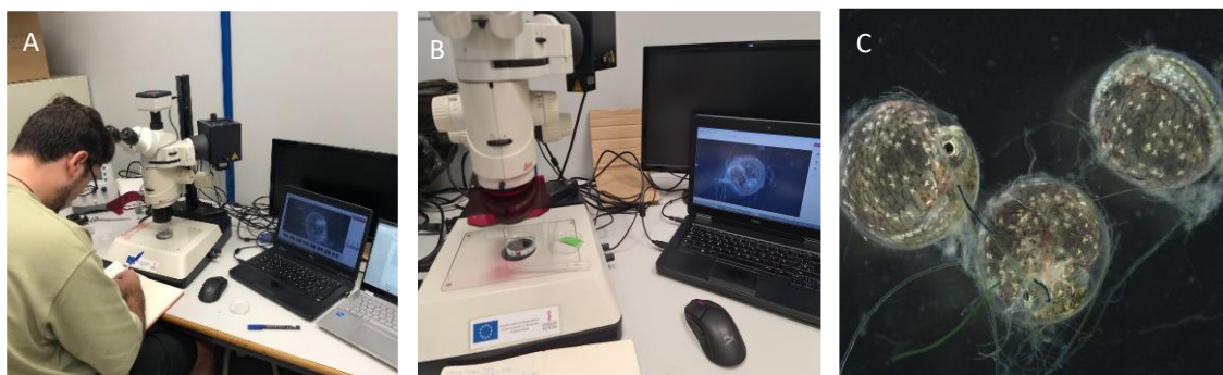
Figura 5. A) Proceso de observación de los embriones y toma de datos. B) Lupa Leica y Moticam 1080N conectada a un ordenador. C) Embriones de samaruc.
