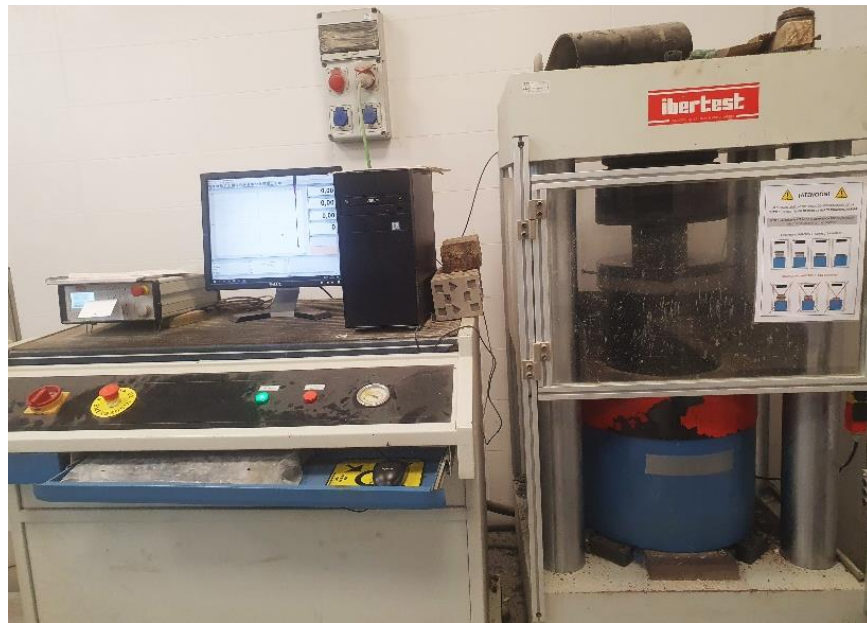
Figura 47: Ensayos a compresión del hormigón
