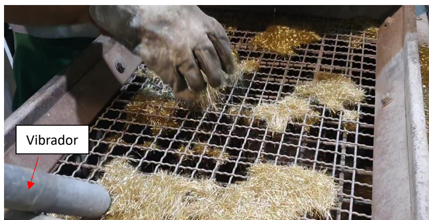
Figura 42: Colocación de las fibras en la mezcladora.
