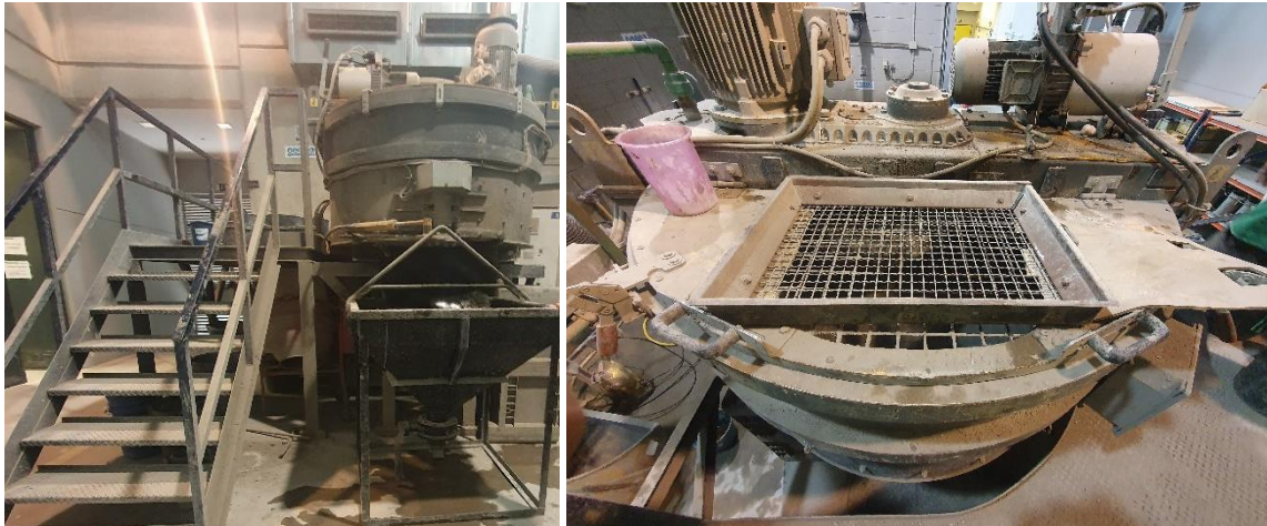
Figura 41: Amasadora empleada para la fabricación de hormigón
