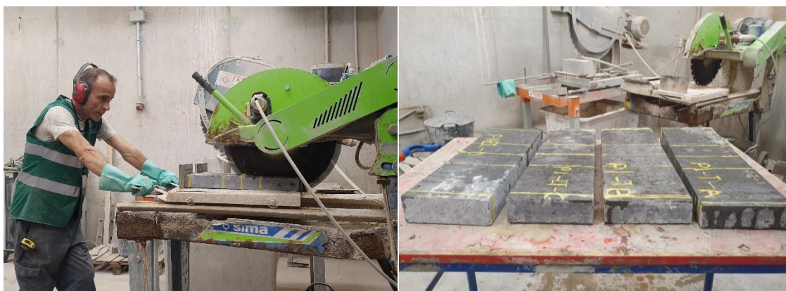
Figura 45: Procedimiento de corte de losas
