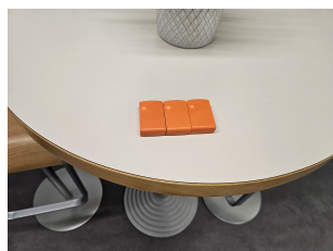
Figura 2.6: Colocación de las IMUs durante el reinicio de la orientación.
