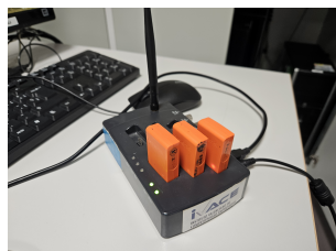
Figura 2.4: IMUs conectadas a la estación maestra de Awinda para la configuración inicial.
