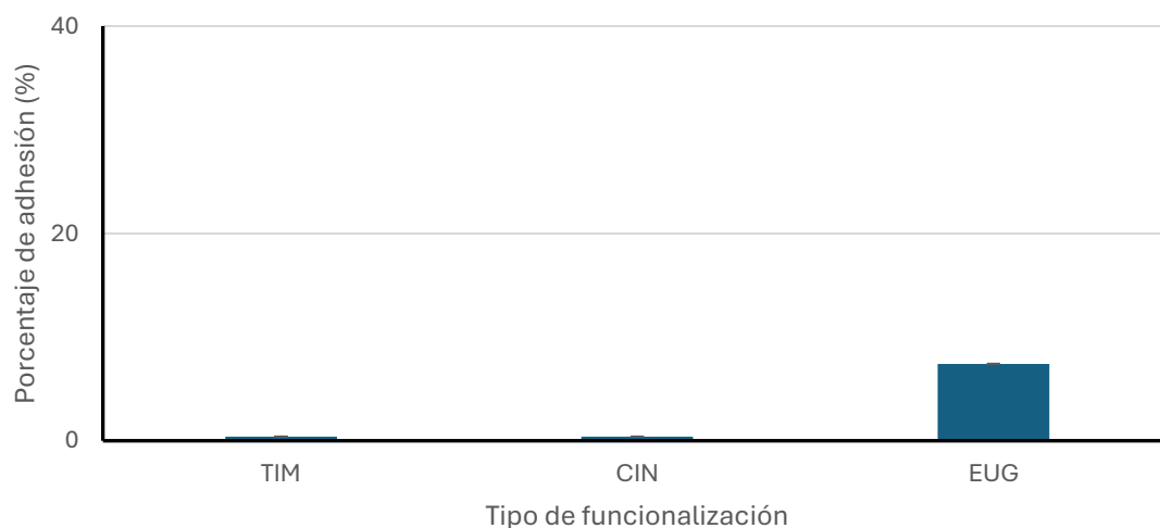
FIGURA 7. Porcentaje de adhesión según las distintas placas usadas, siendo funcionalizadas con TIM (timol), CIN (cinamaldehído) y EUG (eugenol).
