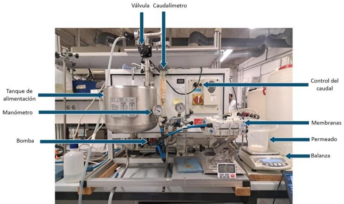
Figura 18: Fotografía de la instalación de ultrafiltración
