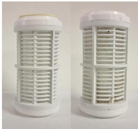
Figura 36: Filtro de 60  $\mu\text{m}$  antes (izquierda) y después (derecha) de filtrar la corriente de escurrido
