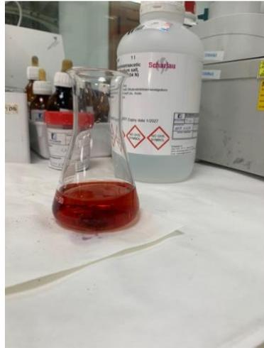
**Figura 9. Muestra de agua con indicador Negro de Eriocromo T. (Fuente: elaboración propia)**
