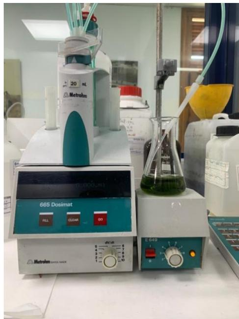
**Figura 10. Determinación de la dureza total ( $\text{CaCO}_3$ )  $\text{Ca}^{+2} + \text{Mg}^{+2}$ . (Fuente: elaboración propia).**
