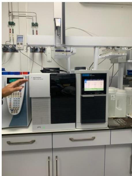
*Figura 13. Cromatógrafo de gases con espectrometría de masas de triple cuadrupolo (Fuente: elaboración propia).*
