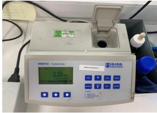
*Figura 8: Turbidímetro utilizado en el laboratorio La Presa. (Fuente: elaboración propia)*
