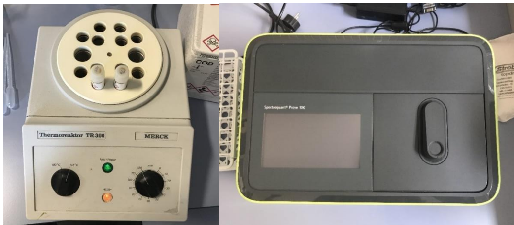
Figura 8: Termorreaktor y espectrofotómetro.
