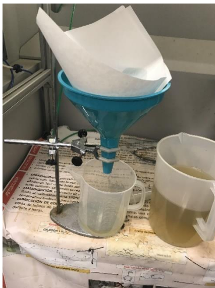
Figura 16: Filtrado de aguas salobres.
