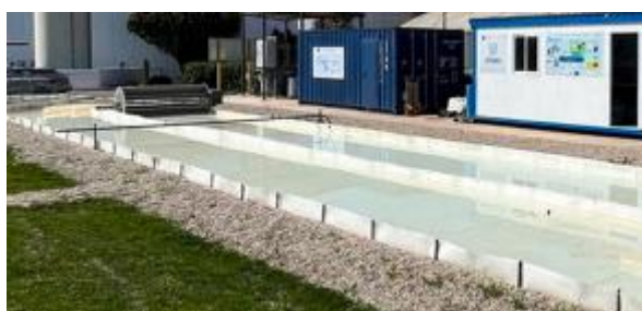
Figura 69: Prototipo de reactor raceway pond reactor para el proyecto [38]
