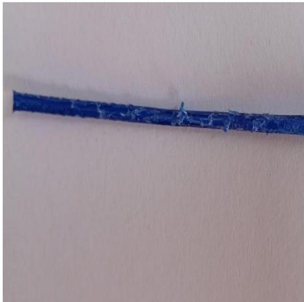
*Ilustración 40. Filamento PET extruido con 7 kg de fuerza.*
