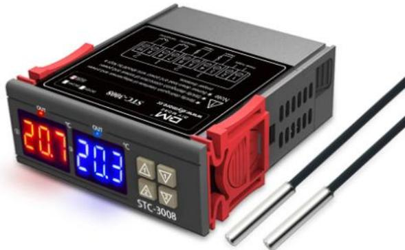
Ilustración 8. Controlador de temperatura digital modelo STC-3008, con medición máxima hasta los 120 °C, alarma integrada y alimentado a 12 V.
