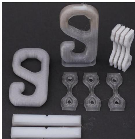
*Ilustración 1. Probetas impresas en 3D para comprobación de prestaciones de distintos materiales.*
