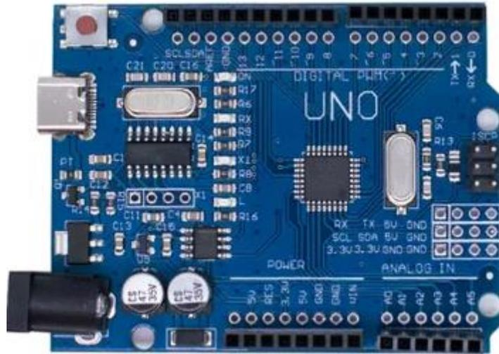
*Ilustración 15. Arduino Uno modelo R3 MEGA 328P, 4 pines de entrada/salida digital (de los cuales 4 pueden ser utilizados para salidas PWM), 6 entradas análogas y un resonador cerámico de 16 MHz.*
