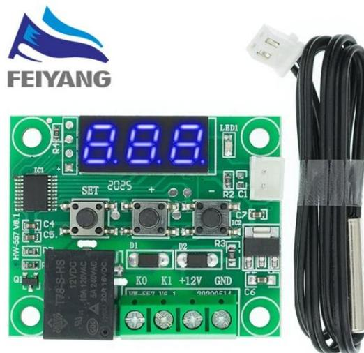
*Ilustración 7. Controlador de temperatura de configuración manual, con medición máxima hasta los 110 °C y alimentado por 5 V, previo a modificación.*
