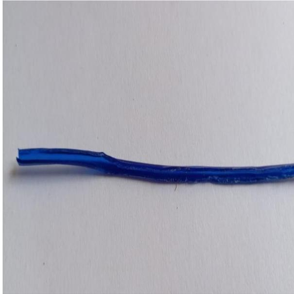
*Ilustración 39. Filamento PET extruido con 1 kg de fuerza.*
