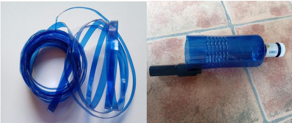
*Ilustración 36. Proceso de conversión de botellas PET en tiras plásticas mediante una guía manual de corte.*
