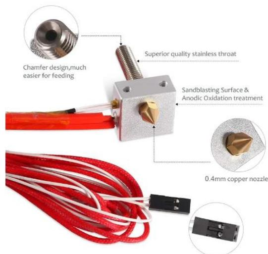
Ilustración 9. Pack con bloque calefactable hasta 280 °C y una potencia de 40 W, boquilla de 0.4 mm y termistor que ofrece la marca AOKIN.
