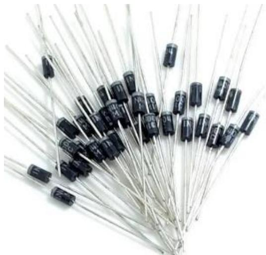
*Ilustración 11. Diodos rectificadores 1N408 necesarios para ajustar la lectura de nuestro controlador de temperatura y así lograr medir al menos 200 °C.*
