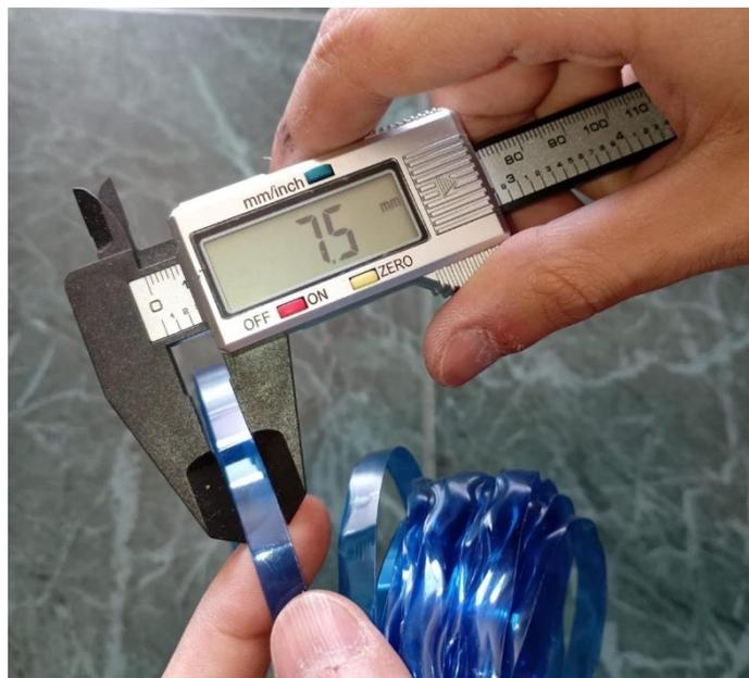
*Ilustración 37. Medición de tiras PET para asegurar un correcto proceso de pultrusión, así como una correcta estabilidad dimensional en el filamento.*
