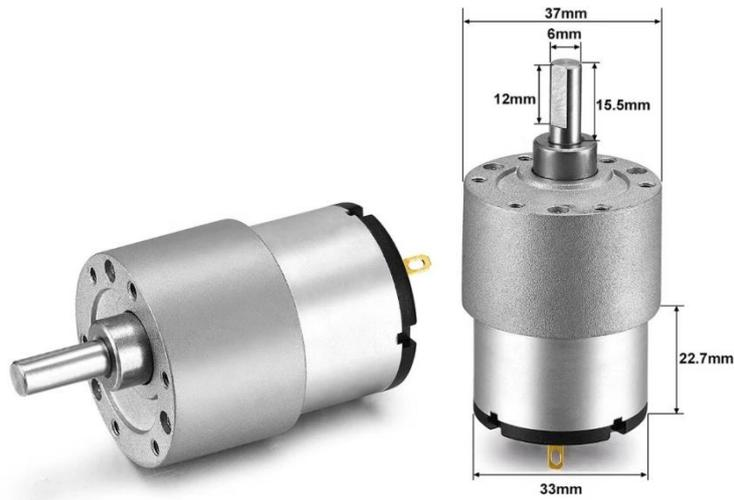
Ilustración 5. Motor DC 12 voltios con caja de engranajes metálica incorporada y velocidad angular del vástago de 7 RPM.
