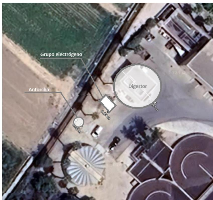
Figura 6.1: Disposición a escala real del digestor anaerobio y otros equipos. FUENTE: Elaboración propia.
