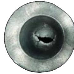
Figura 11: Muestra tras el ensayo Small Punch (Arunkumar, 2019)
