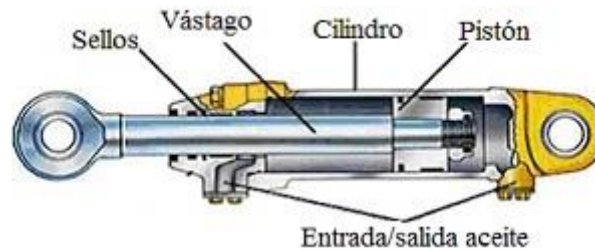
Figura 3. Partes cilindro hidráulico de doble efecto
