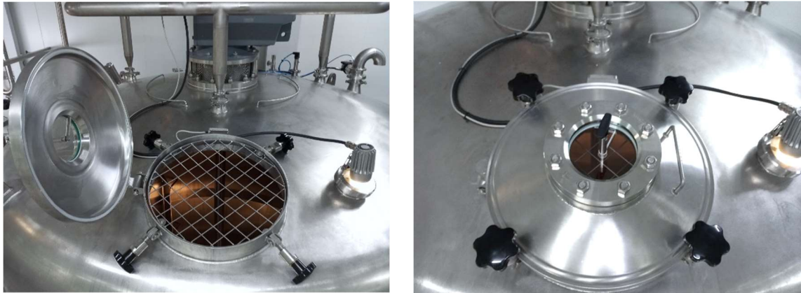
Figura 8. Boca de hombre de los reactores.
