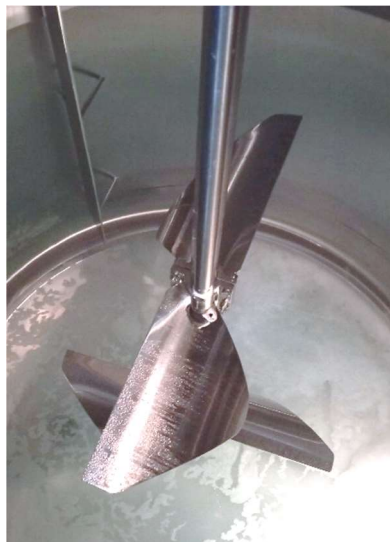
Figura 9. Agitador vertical tipo doble flujo del reactor.
