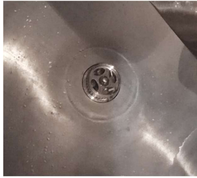
Figura 10. Agitador de fondo tipo disco dispersador del reactor.
