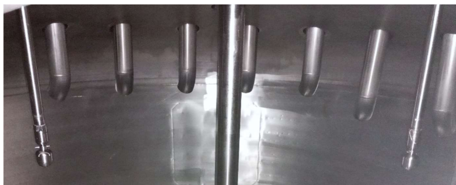
Figura 14. Bolas de limpieza de los reactores.
