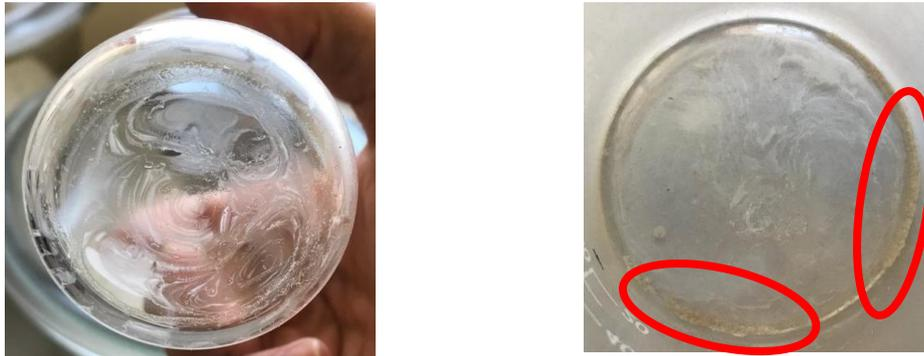
**FIGURA 7.** Residuos del ensayo de migración en vasos de precipitado.
