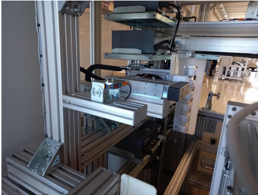
Figura 38. Fotocélula de detección de orientación del microondas
