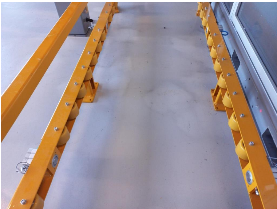
Figura 37. Sistema de raíles y pistones de fijación del carro
