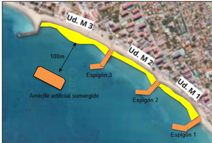
Figura 21. Estimación del efecto de la propuesta óptima combinados con los resultados de la hipótesis de Pelnard-Considère. Nota: las nuevas infraestructuras se representan en color naranja, mientras que la posición estimada de la línea de costa en color amarillo.
