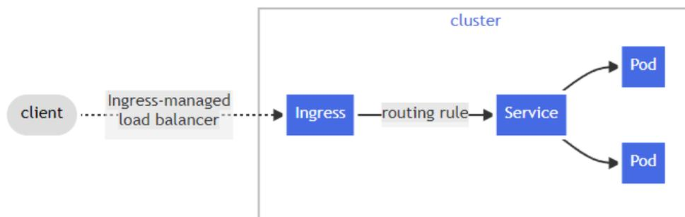
Figura A.8: Ejemplo de funcionamiento del Ingress
