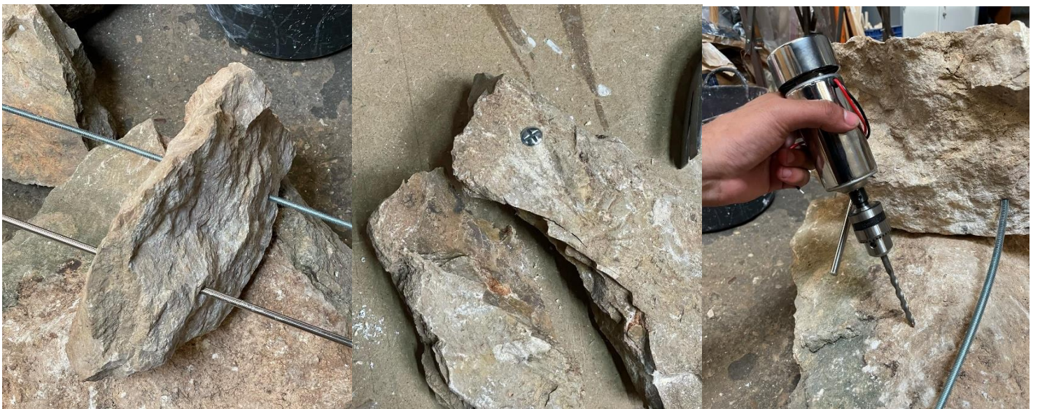
Figura 44. Fotografías de pruebas de perforación de rocas.
