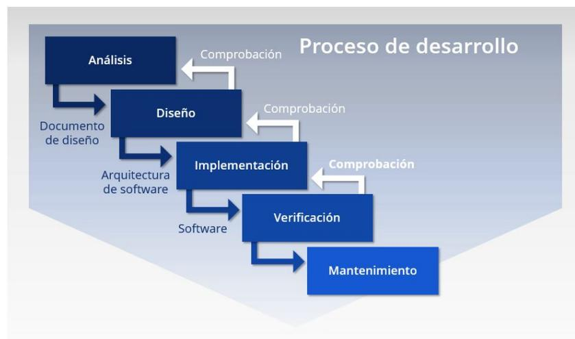
Figura 4.1: Esquema del modelo de desarrollo en cascada [35]
