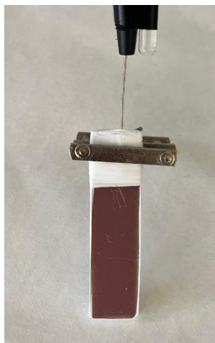
Figura 10. Imagen del electrodo cerámico preparado para los ensayos de degradación.
