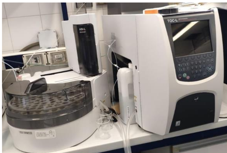
Figura 17. Analizador de carbono orgánico Shimadzu TNM-L ROHS.
