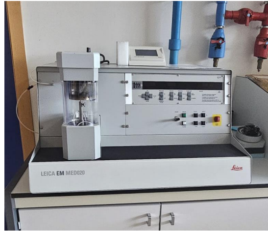
Figura 22. Equipo de recubrimiento Leica EM MED020.
