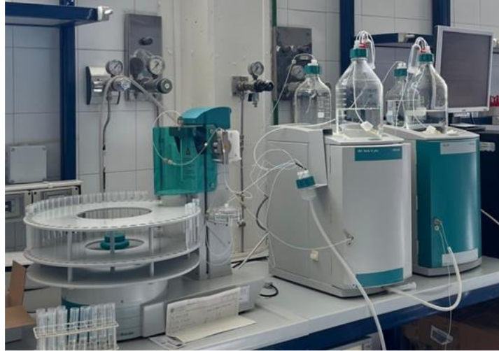
Figura 18. Cromatógrafo iónico Metrohm 883 Basic IC Plus.
