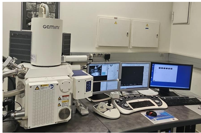
Figura 23. Microscopio Electrónico de Barrido de Emisión de Campo (SEM) ZEISS ULTRA 55.
