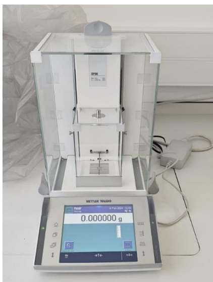
Figura 6. Balanza analítica Mettler Toledo XP56.
