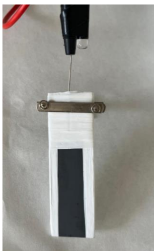
Figura 11. Imagen del electrodo BDD utilizado en los ensayos de degradación.
