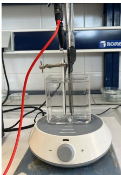
Figura 12. Montaje experimental para llevar a cabo los ensayos de degradación.
