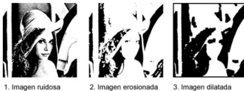
**Figura 2.7:** Eliminación de ruido mediante erosión y dilatación.
