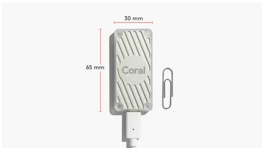
**Figura 2.6:** Unidad de procesamiento tensorial (TPU) usada en este proyecto.
