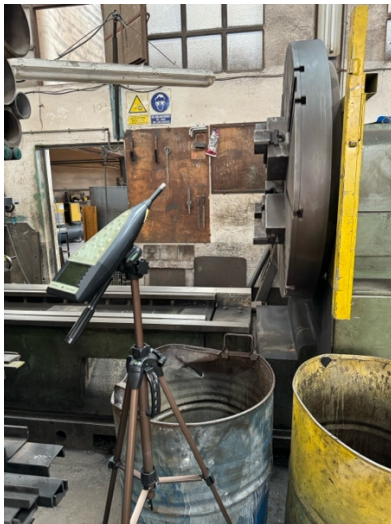
Figura 7. Sonómetro en medición de ruido del torno grande.
