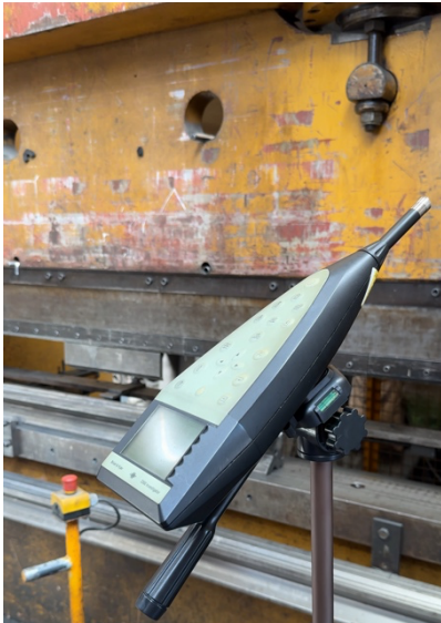
Figura 15. Sonómetro en medición de ruido de la plegadora en acción.
