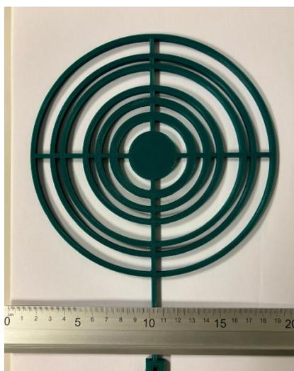
**Figura 20. Lente fresnel con máscara de números primo impresión 3D**
