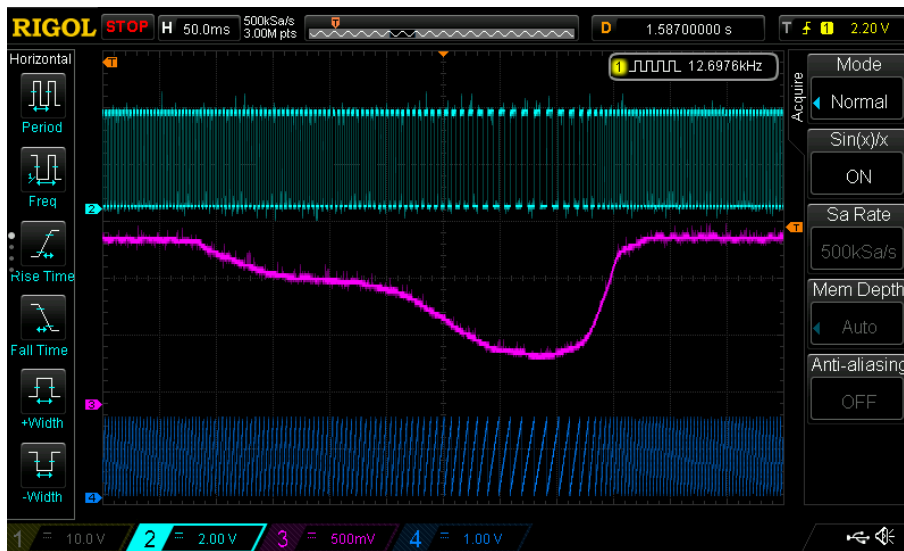
Figura 4.23: Sensor Hall A, velocidad constante con escalón de carga y fase con SOGI-FLL sincronizado
